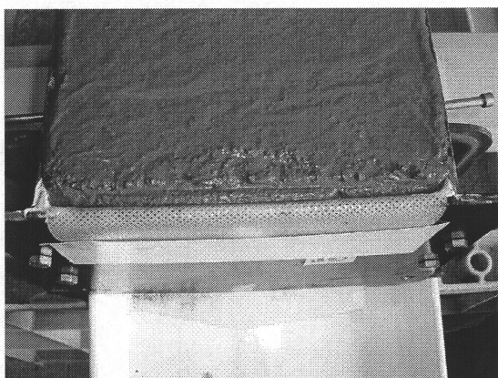
写真 3-7 親水性塗料を噴霧した試験体 （ブリーディングが無い）
