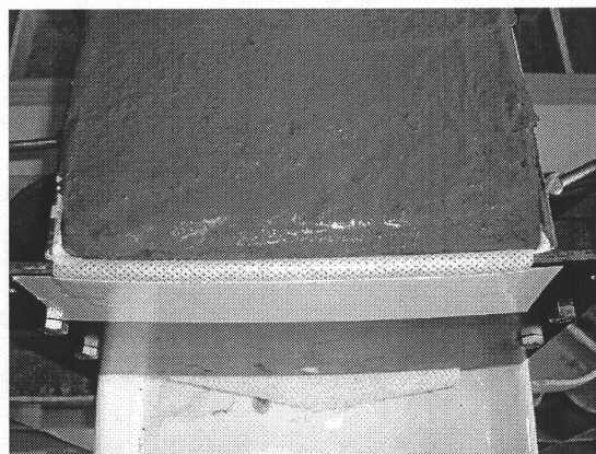
写真 3-8 シート側にブリーディングが 貯まっている試験体の様子
