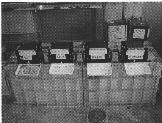
写真 3-6 小型試験体による透水実験の様子
