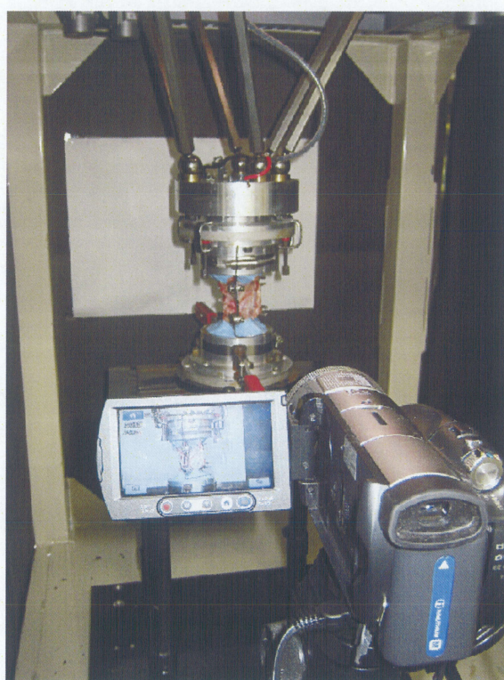
図 6.5 椎体とスクリューの挙動観察の実験風景
