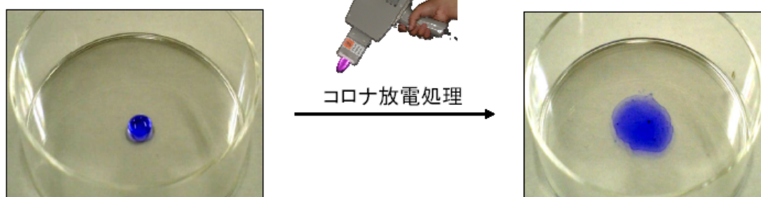
図 8-1 コロナ放電処理前後のシャーレ表面の様子
