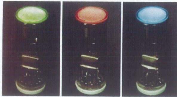
Fig.1-1 カーボンナノチューブ電子源を利用した蛍光表示管
