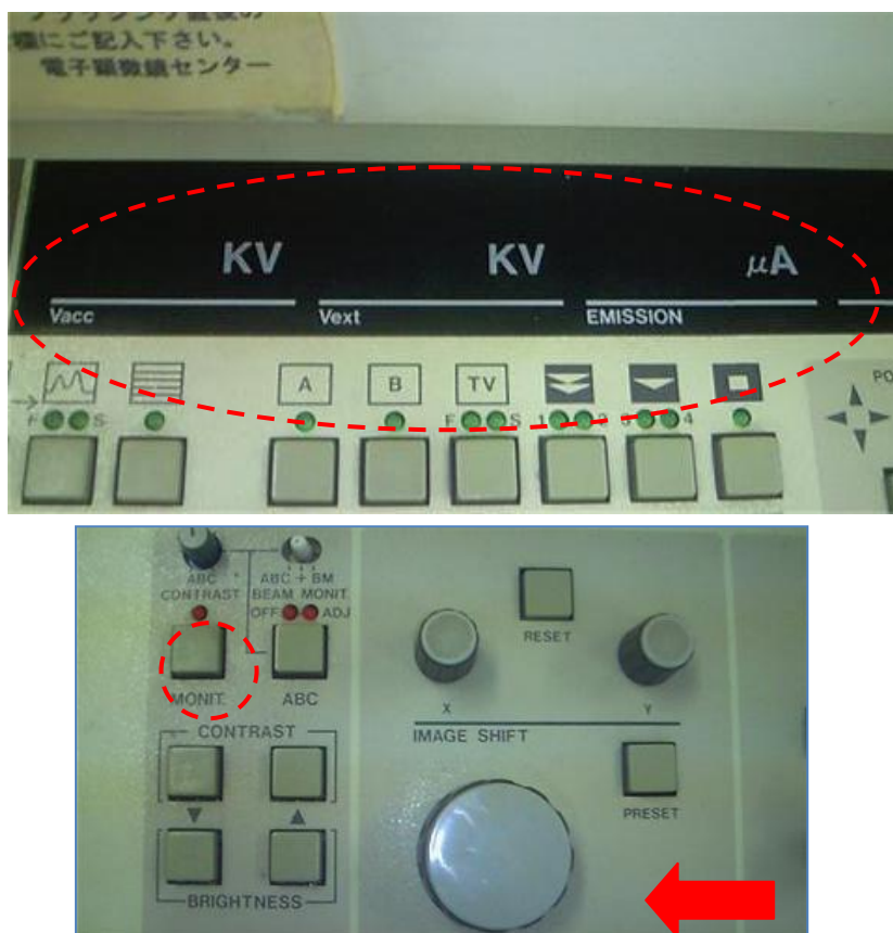
図 8-11 上図: Vacc、Vext、EMISSION、下図:コントラスト及び撮影倍率調整
