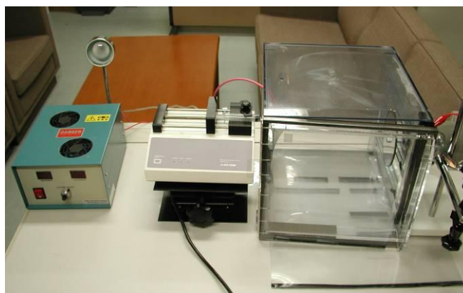
図 8-6 エレクトロスピンニング装置
