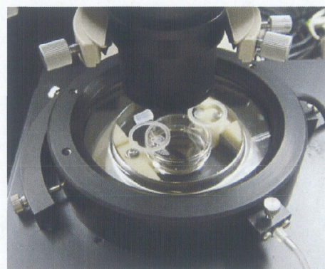
図 8-12 顕微鏡付属培養装置
