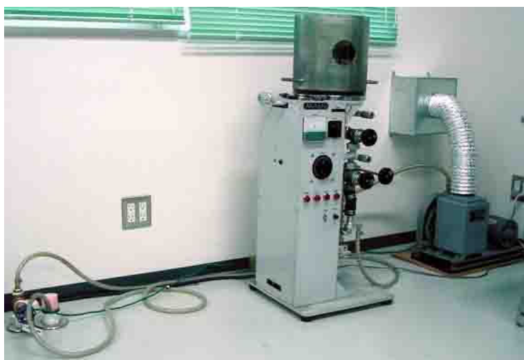
Fig.2.4 真空蒸着装置外観
