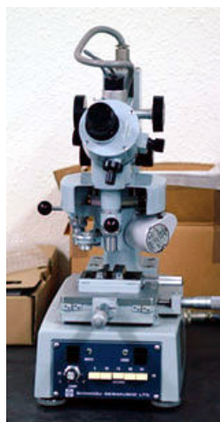
Fig.2.7 ビッカース硬さ試験機
