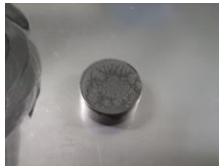
Fig. 2.15 研磨中の工具表面(WA#4000)
