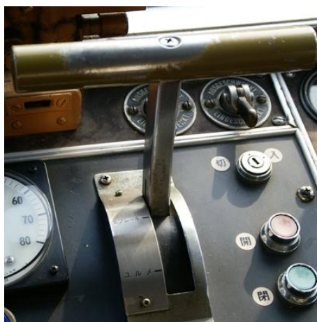
Fig.1.2 従来方式のブレーキハンドル
