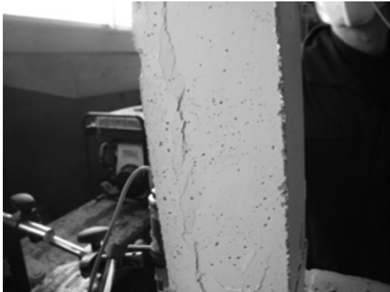
写真 3.3.3 付着ひび割れ (Fc7C-1)
