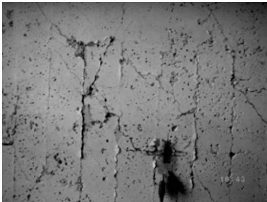
写真 4.3.3 付着ひび割れ (Fc7W-2)
