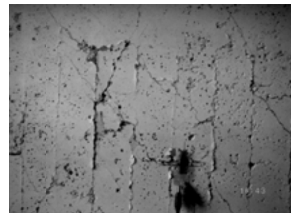
写真-6 付着ひび割れ (Fc7W-2)
