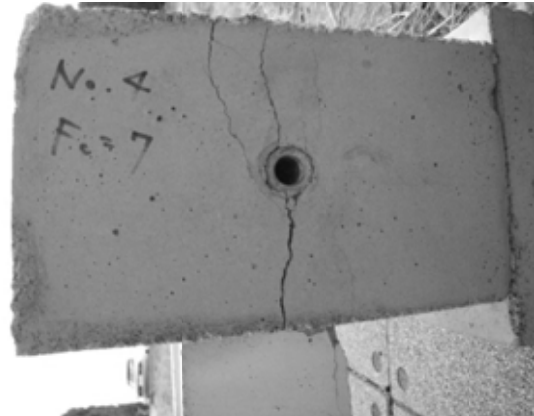
写真 3.3.4 梁のひび割れ (Fc7C-2)
