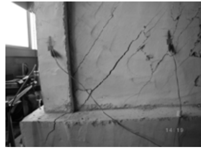
写真-4 ひび割れ性状 (Fc21W-2)
