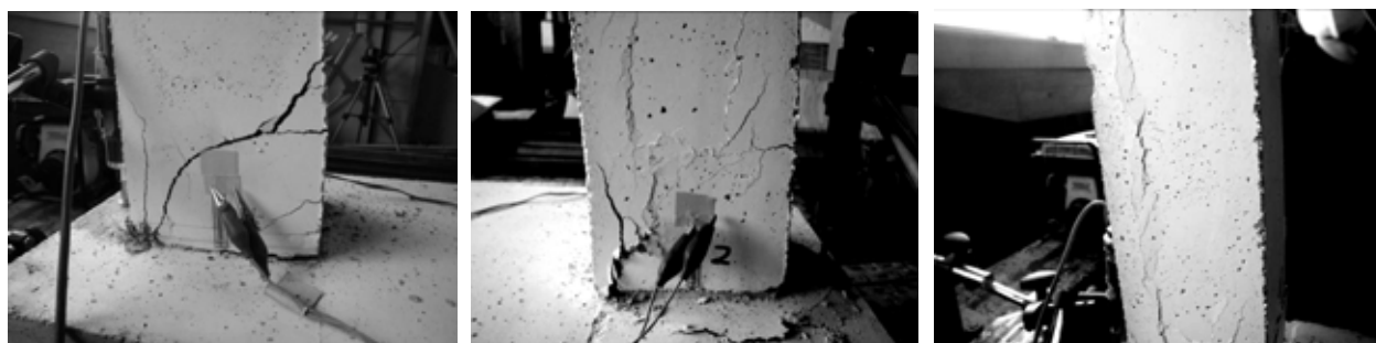
写真-1 ひび割れ性状 (Fc21C-2 試験体) 写真-2 ひび割れ性状 (Fc7C-1 試験体) 写真-3 付着破壊 (Fc7C-1 試験体)
