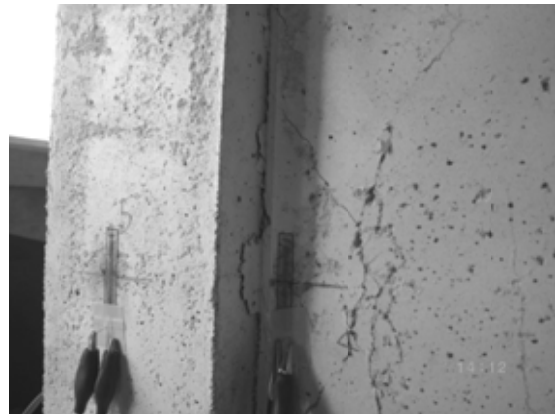
写真 4.3.4 スリップひび割れ (Fc7W-1)
