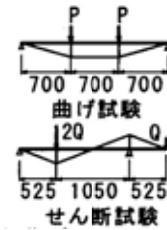
図 2.3.4 載荷方法とモーメント図
