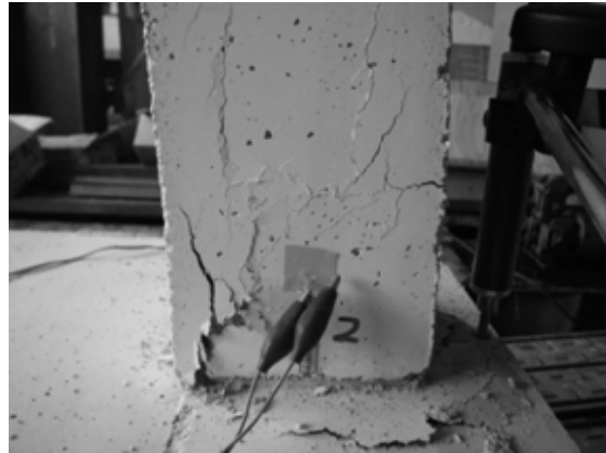
写真 3.3.2 ひび割れ性状 (Fc7C-1)
