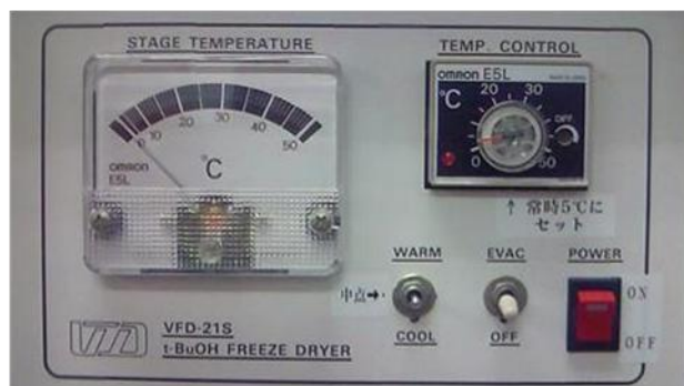
図 8-2 t-ブチルアルコール用凍結乾燥機 (VFD-21S)
