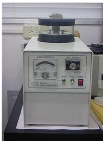
図 8-2 t-ブチルアルコール用凍結乾燥機 (VFD-21S)
