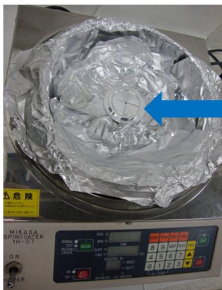
Figure 1. スピンコーターと試料台の写真 a) スピンコーター、b) 試料台
