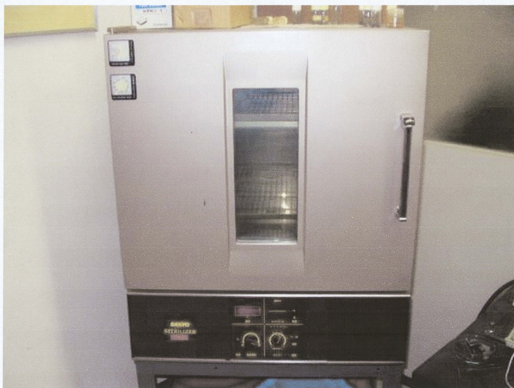
図 4.22 乾熱滅菌器の外観写真
