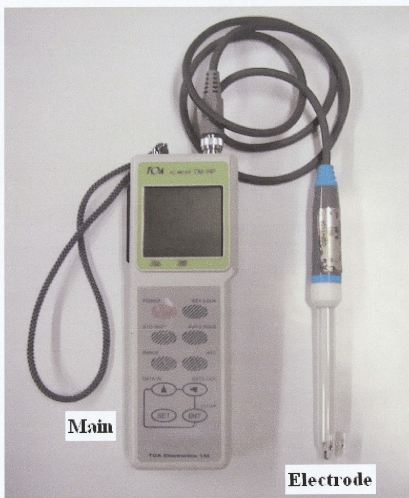
図 4.1 電気伝導率計の外観写真
