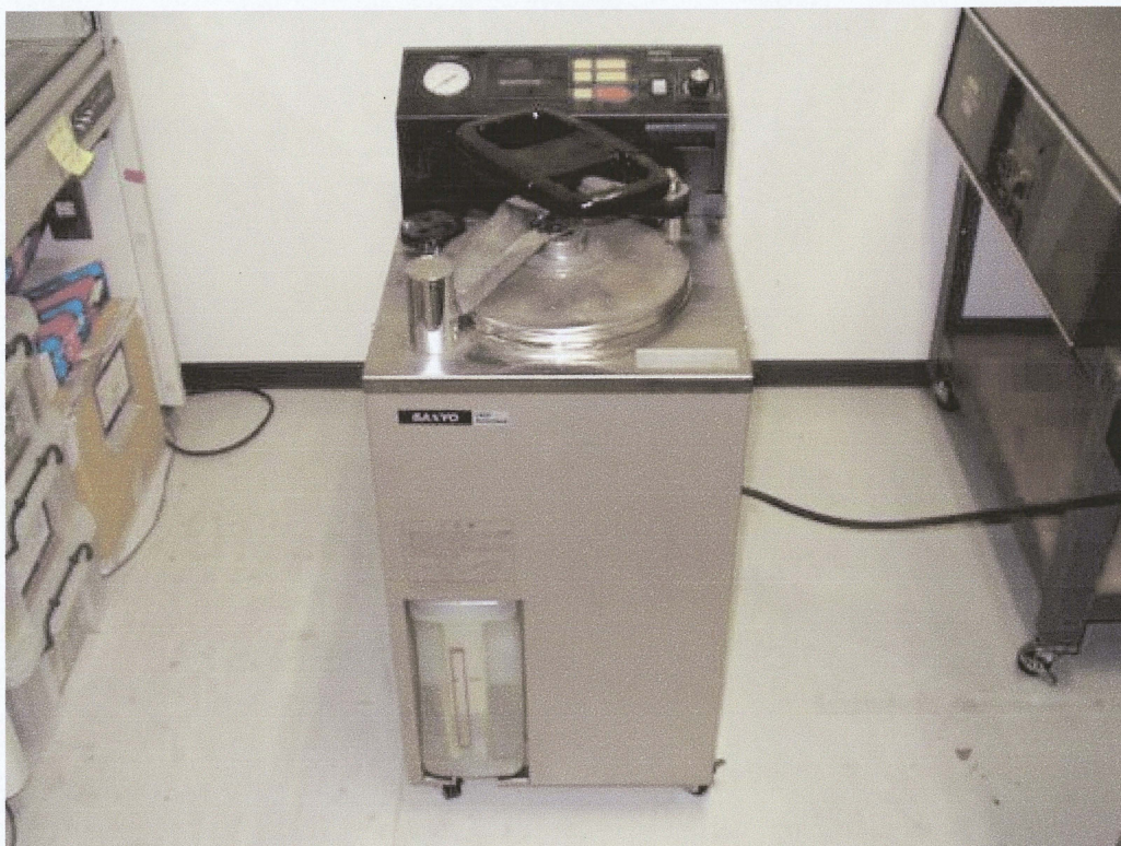
図 4.23 オートクレーブの外観写真
