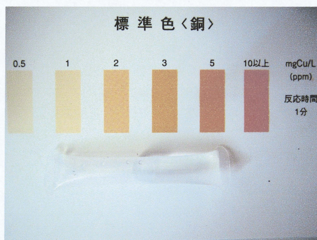
図 4.4 パックテストの外観写真
