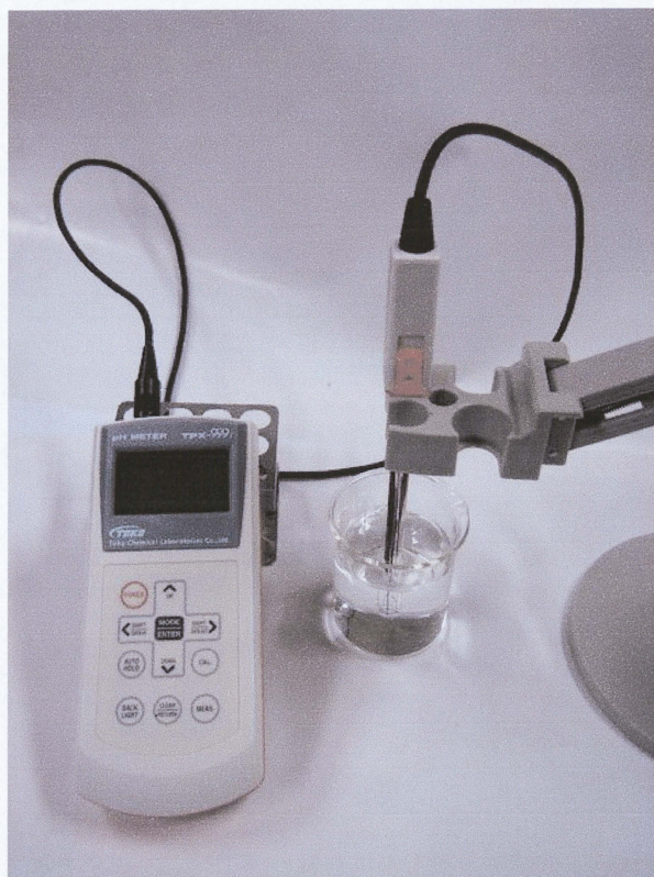
図 4.2 pH メータ計の外観写真
