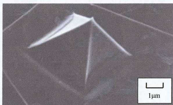
Fig.2.9 測定用プローブの SEM 像
