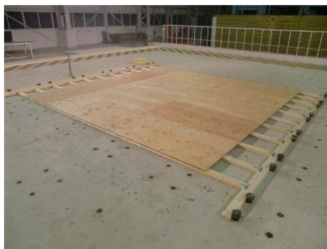
写真 3.8 振動台上に設置した床の様子
