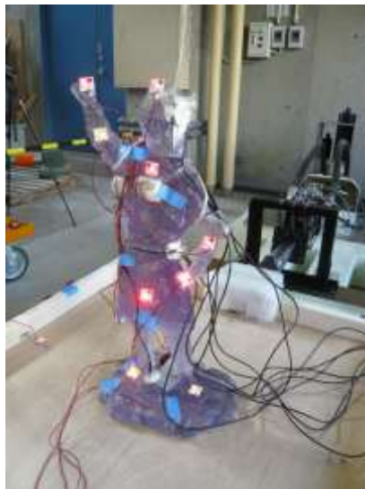
写真 2.6 試験体マーカ設置状況
