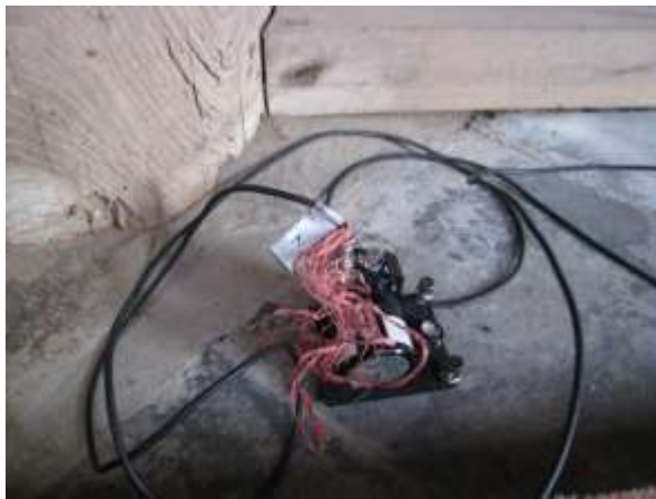
写真 4.5 正堂基壇上の速度計
