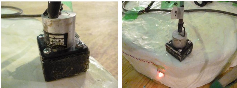
写真 3.10 加速度計設置の様子
