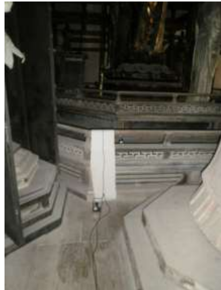
写真 4.10 八角須弥壇の速度計
