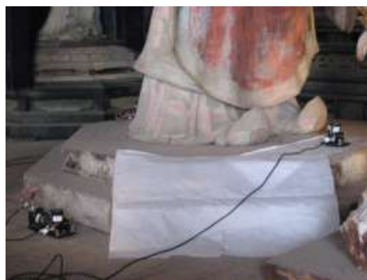
写真 4.11 乾漆帝釈天像台座の速度計
