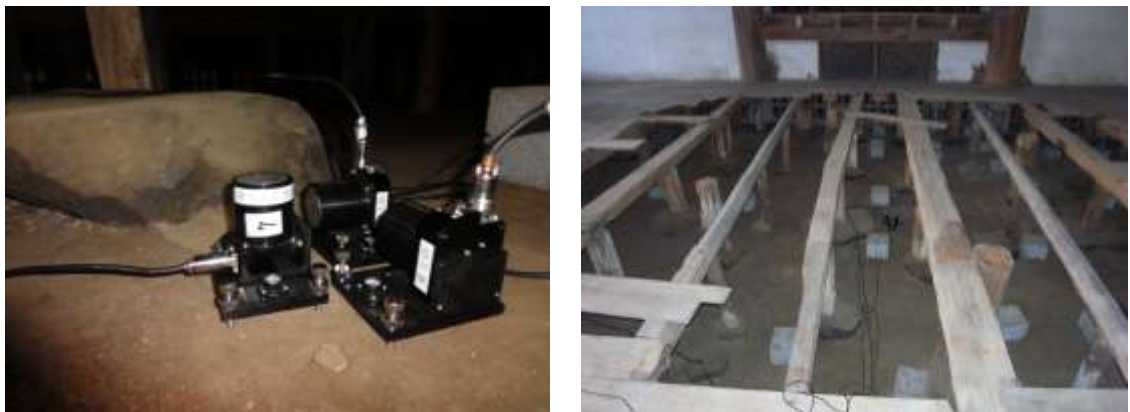
写真 4.12 版築の速度計
