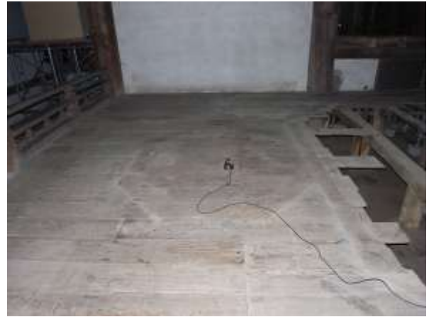
写真 4.8 建築須弥壇の速度計
