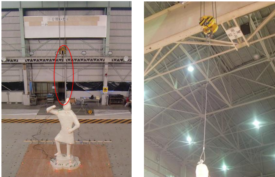
写真 3.9 転倒防止のワイヤーロープの様子
