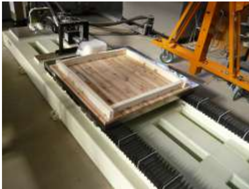
写真 2.3 水平一軸振動台
