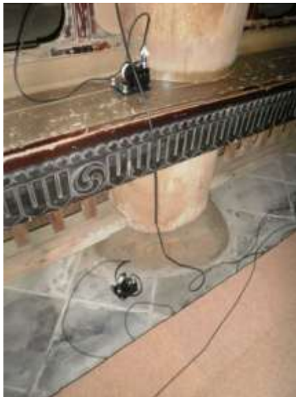
写真 4.9 基壇及び建築須弥壇の速度計
