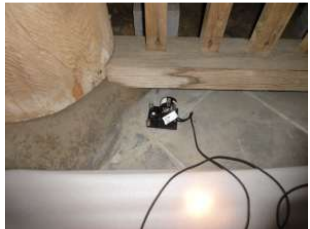
写真 4.5 正堂基壇上の速度計
