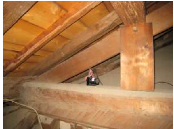
写真 4.4 小屋裏の速度計
