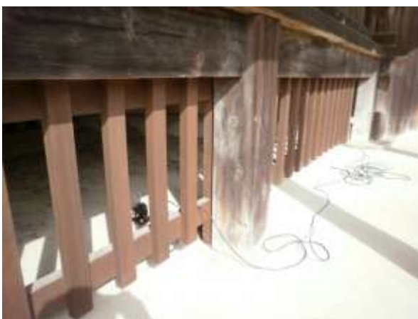
写真 4.6 礼堂基壇の速度計
