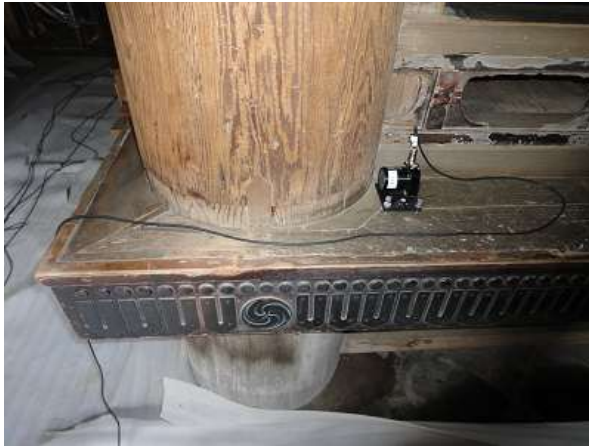
写真 4.8 建築須弥壇の速度計
