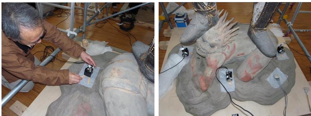
写真 3.6 速度計設置の様子
