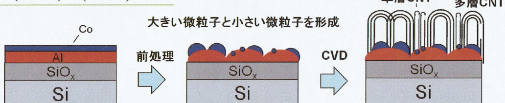
図 4.4.7 650、550℃における触媒膜厚の違いによるモデル図
