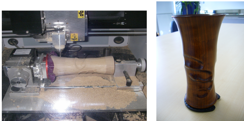
(a) 三次元切削機による木地の切削 (b) 完成した我杯
