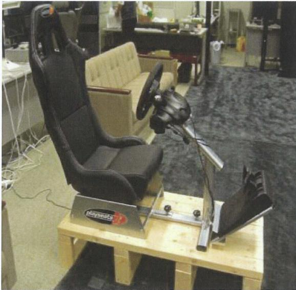
図 4.3.2 ステアリング入力装置
