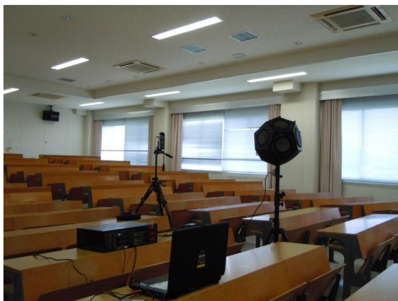
写真 1-1 インパルス応答測定模様
