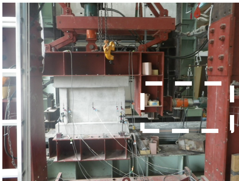
写真 3.2.1 試験体設置状況（反曲点高さ比 0.5）
