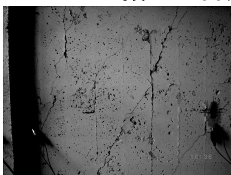
写真 2.3.6 ひび割れ性状 (Fc7W-2) 19) 写真 2.3.7 付着ひび割れ (Fc7W-2) 19)
