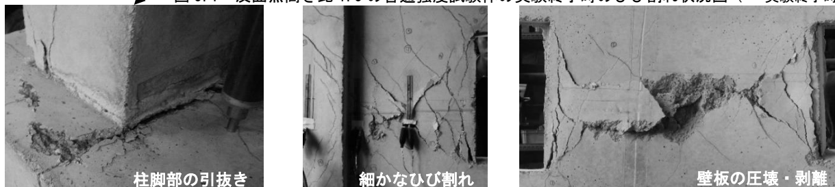
図 5.1 反曲点高さ比 1.5 の普通強度試験体の実験終了時のひび割れ状況図 (→:実験終了時の加力方向)
