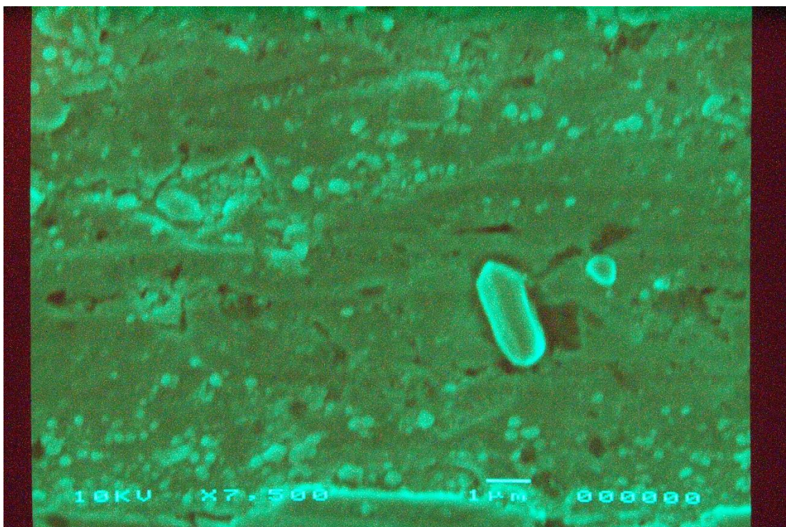
図 3.60 試験後の海水で確認された短桿菌と球菌（標準試験，無酸素銅，28 日）
