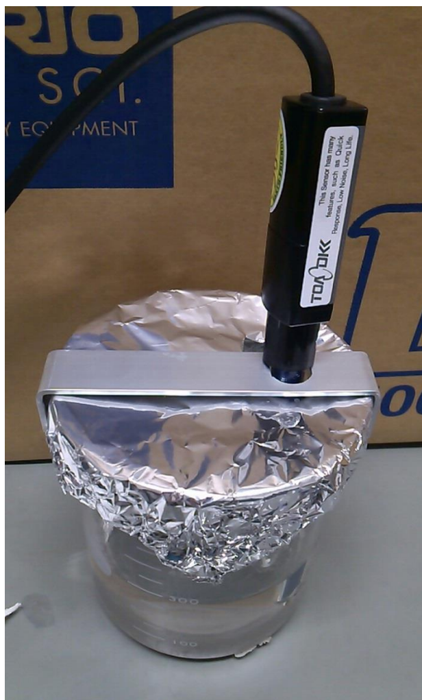
図 2.2 Electrode holder の保管方法
