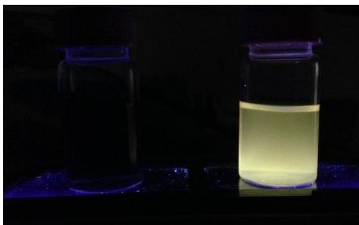
図 4.18 紫外線下の光学写真(左：CNPaq、右：CNPOaq)
