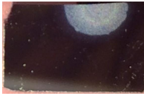
図 4.2.2 Ni 触媒上でグラフェン成長させた基板表面の様子
