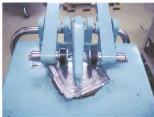
写真 4-3 テーパー摩耗試験の状況
