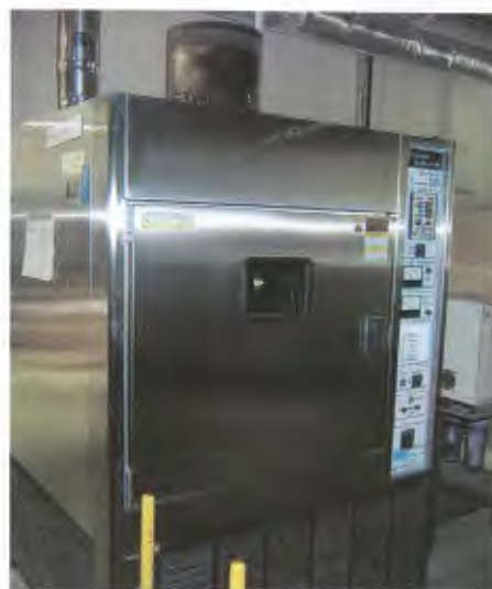
写真 4-2 サンシャインウェザー試験機外観
