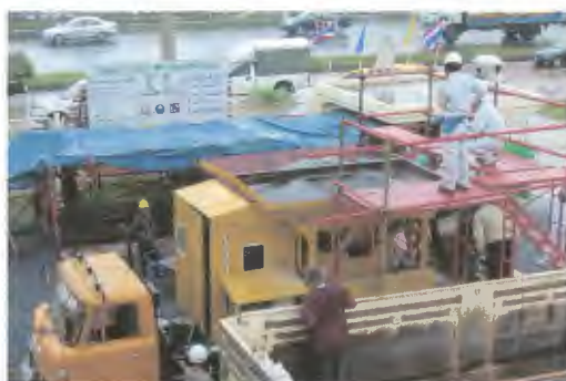
写真 5-7 ポーラスコンクリート製造ユニット
