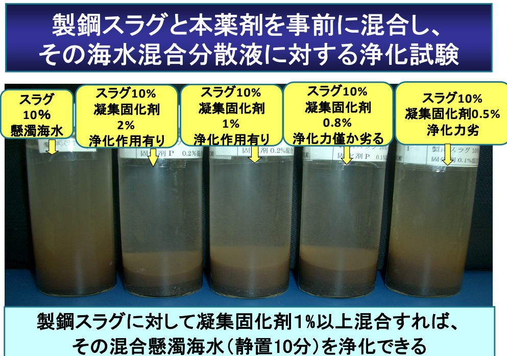
Figure 15. 製鋼スラグと本薬剤を事前に混合し海水中での分散物に対する本薬剤による浄化試験
