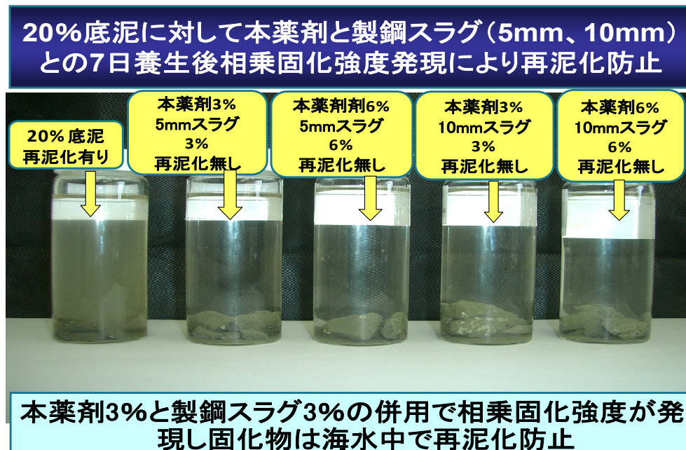
Figure 11. 20%濃度底泥に対して本薬剤と製鋼スラグ(5mm、10mm)との相乗固化強度発現による再泥化防止
