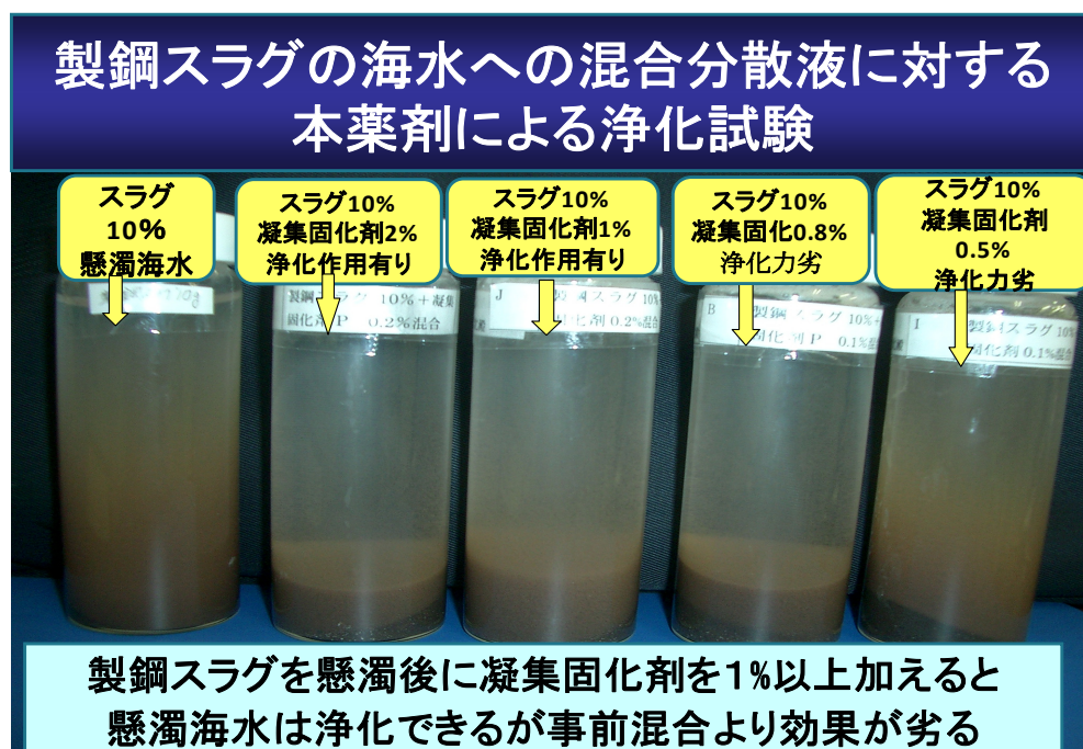
Figure 14. 製鋼スラグを海水に混合分散液に対する本薬剤による浄化試験
