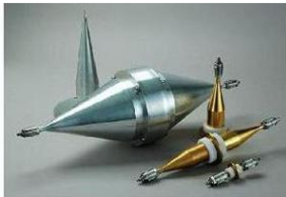
図 2.5 同軸管法で用いられるフォルダ
