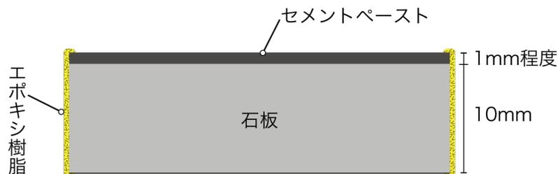
図5.11 模擬ポーラスコンクリート試験体の概要（断面）
