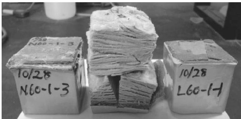
写真2.2 1年間塩化カルシウム水溶液に浸漬した各種セメント硬化体の劣化状況<sup>20)</sup>
