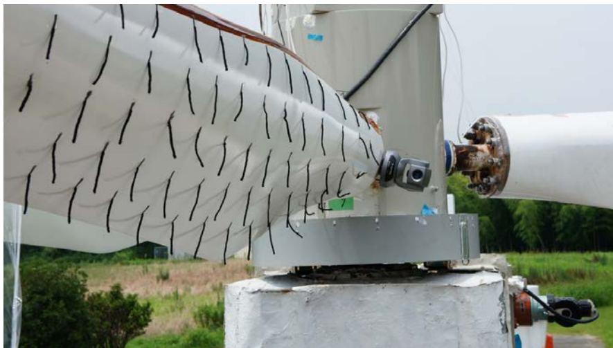
図 4.3.2.1 タフトと監視用カメラの設置状況
