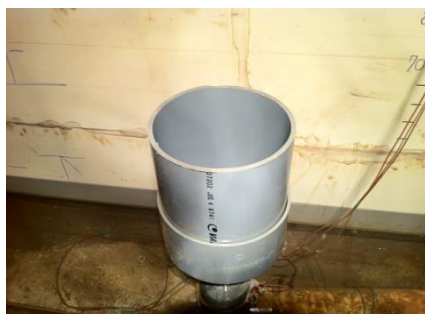
写真 2.4 直管型流入口流入面
