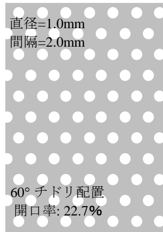
図 2.5 パンチングメタル詳細図
